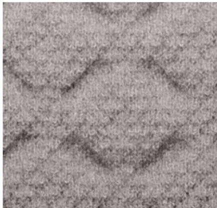
Quilted Knit ist ein Formgestrick aus recyceltem Polyester. Die Strickweise bewirkt einerseits ein zusätzliches Volumen für einen erhöhten Komfort und andererseits eine markante Struktur, die das Erscheinungsbild der Vorderseite der Rückenlehne von ACX Soft prägt.
